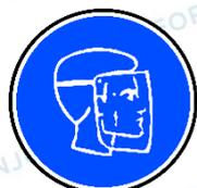
Une visière ou un masque de soudeur conforme à la norme pour se protéger lors des soudures et éviter le contact avec toute étincelle et débris
